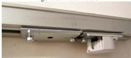
Fig.6 Inserimento blocco tendicinghia
