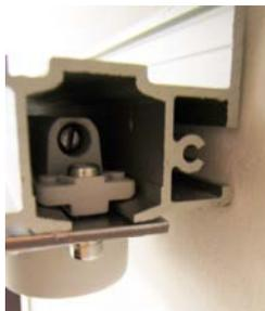
Fig. 10 Particolare dell'albero a vite M8
