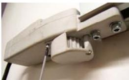
Fig.8 Rimozione della cuffia
